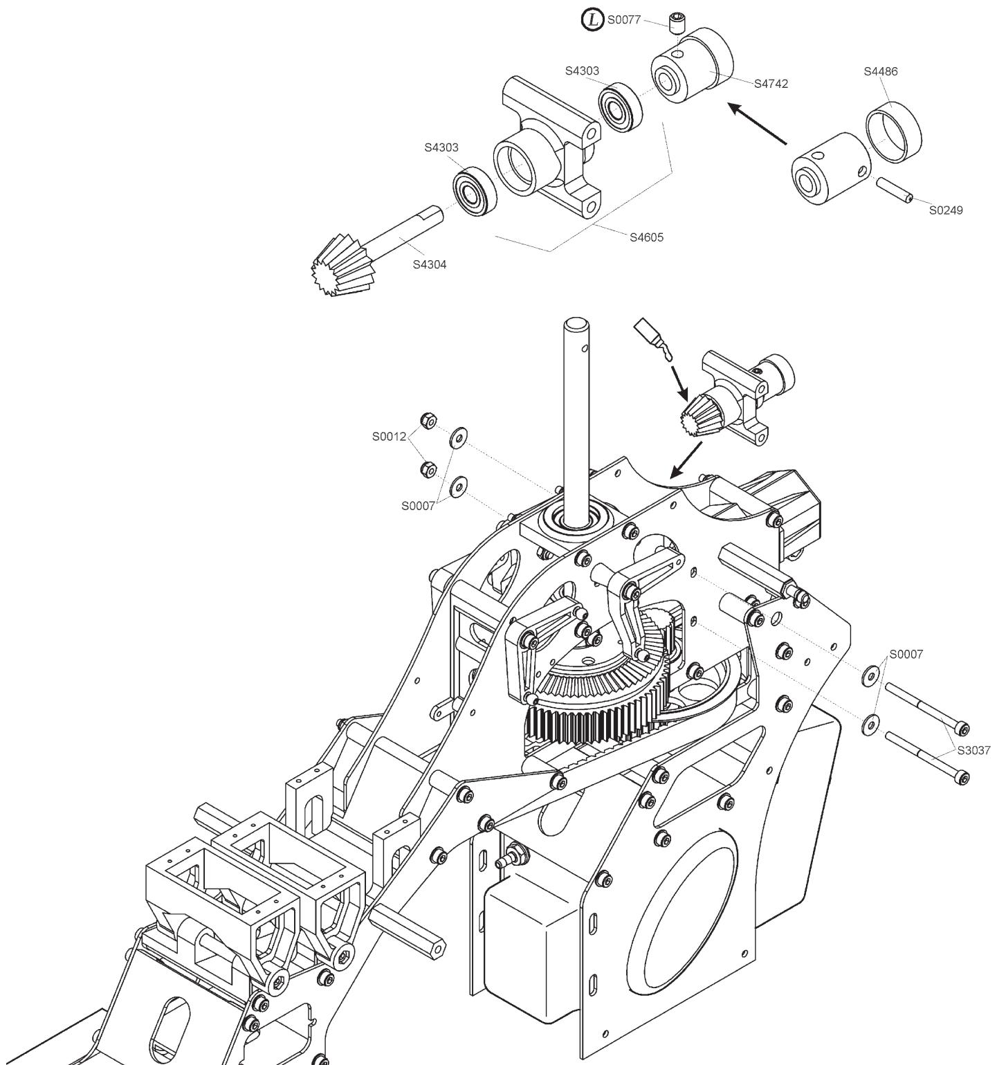
**3.0 Montage Heckabtrieb**
