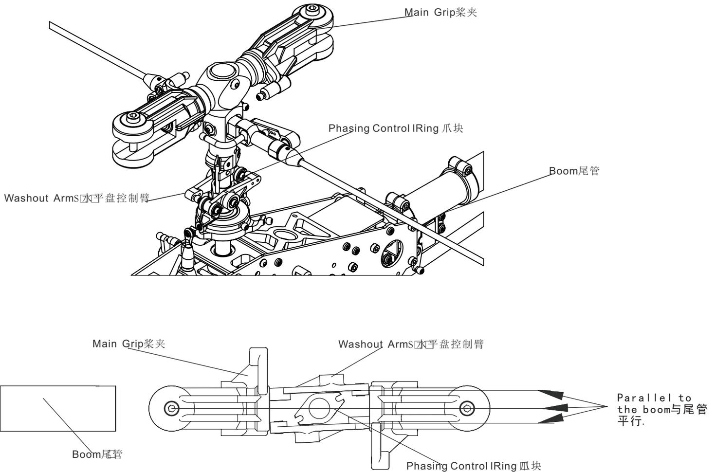
爪块控制组设置的角度应保证水平盘控制臂与桨夹同时平行于尾管。
