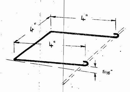
MAIN ROTOR BLADE INCIDENCE GAUGE
