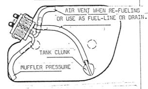
INSTALL THE FUEL STOPPER BETWEEN MUFFLER AND THE TANK AND CLOSE STOPPER WHEN RE-FUELING.
