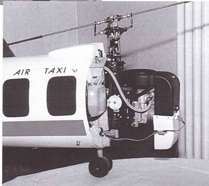
Die Mechanik vorne trägt den Motor und ist somit der eigentliche Antrieb des TWIN STAR.
