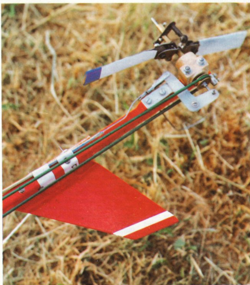
Extrémité arrière de la poutre : la courroie de transmission sur sa poulie Meccano, le renvoi de commande du pas de l'anticouple, le palier en hêtre (en variante).
